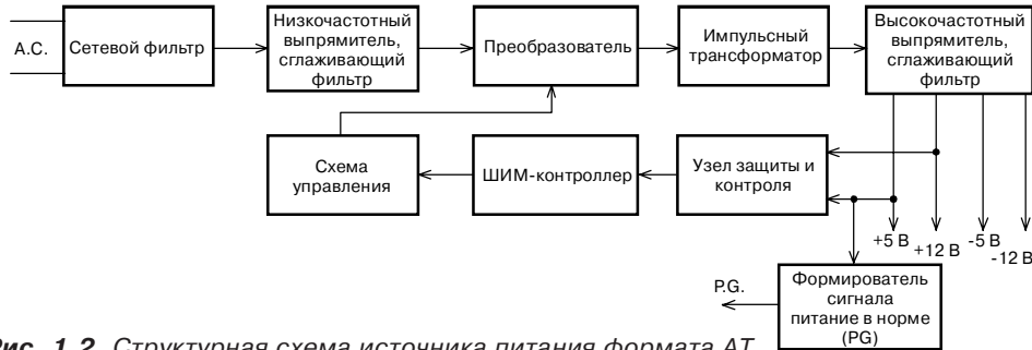
Рис. 1.2. Структурная схема источника питания формата AT
