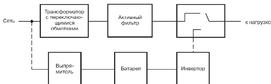
Рис. 4.2. Архитектура источника бесперебойного питания типа Line-Interactive
